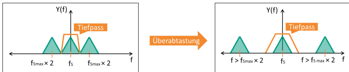
Abbildung 9: Auswirkung des Überabtastens auf das Frequenzspektrum des Signals
