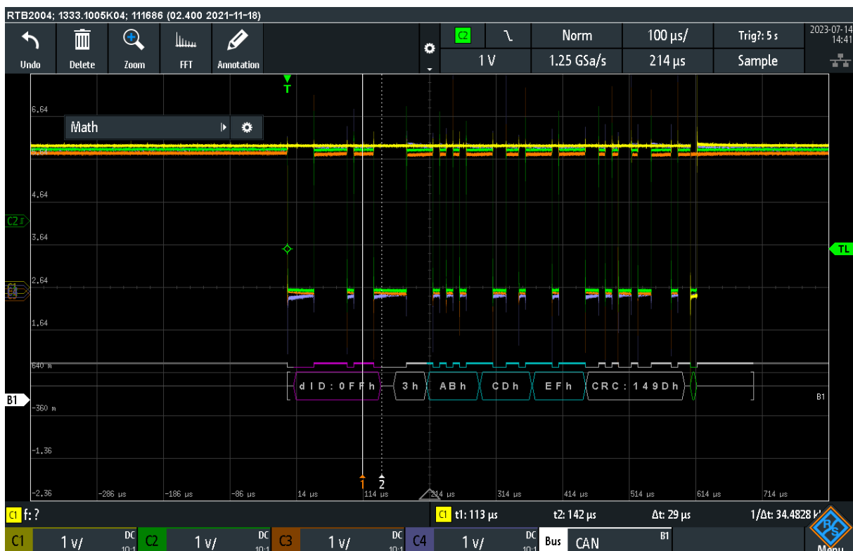
Abbildung 8.4: Auslesen der übertragenen Nachrichten mit dem Oszilloskop
