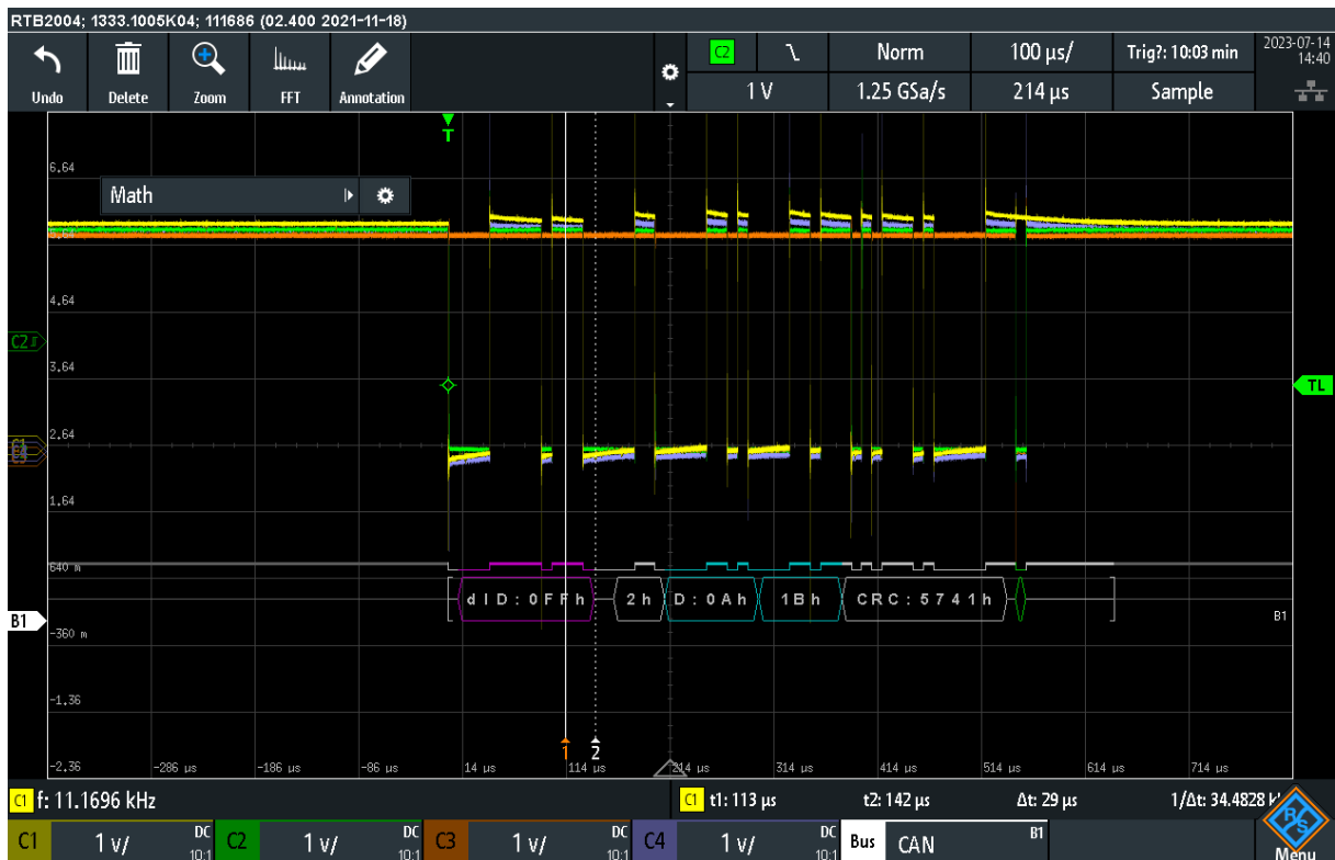
Abbildung 8.5: Auslesen der Empfangenen Nachrichten mit dem Oszilloskop
