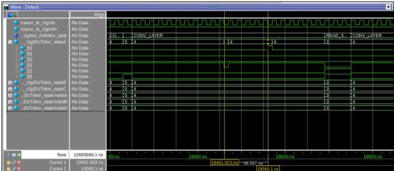
Abbildung 7.4: Simulation der zufälligen Injektion, bei der die Signale dnn_stateA[2] und dnn_stateA[5] zufällig forciert und freigegeben werden.
