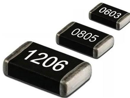
Abbildung 25: SMD-Bauteile
