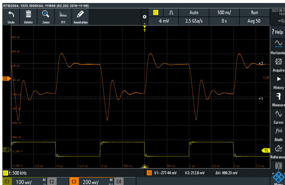
Abbildung 58: Oszillogramm der transienten Messung mit Signalwertmittelung
