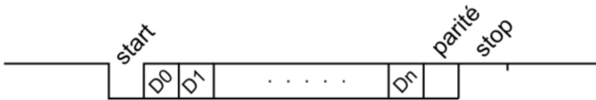
Abbildung 22: Aufbau eines UART-Rahmens [29]
