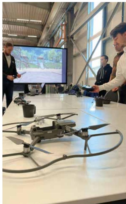
Im Modul Rettungsrobotik lernten die Studierenden die Steuerung und Programmierung von kleinen Übungsdrohnen.
