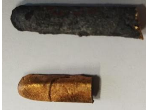
Abb. A-4 Umgeschmolzene Proben. Oben im Ofen ausgekühlt und unten abgeschreckt
