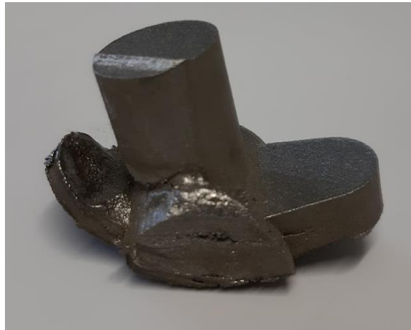
Abb. 2-15 Von der Bauplatte im Fertigungsprozess teilweise abgerissenes Bauteil aus 1.4404. Die starke Verformung führte zu Folgeprozessfehlern.
