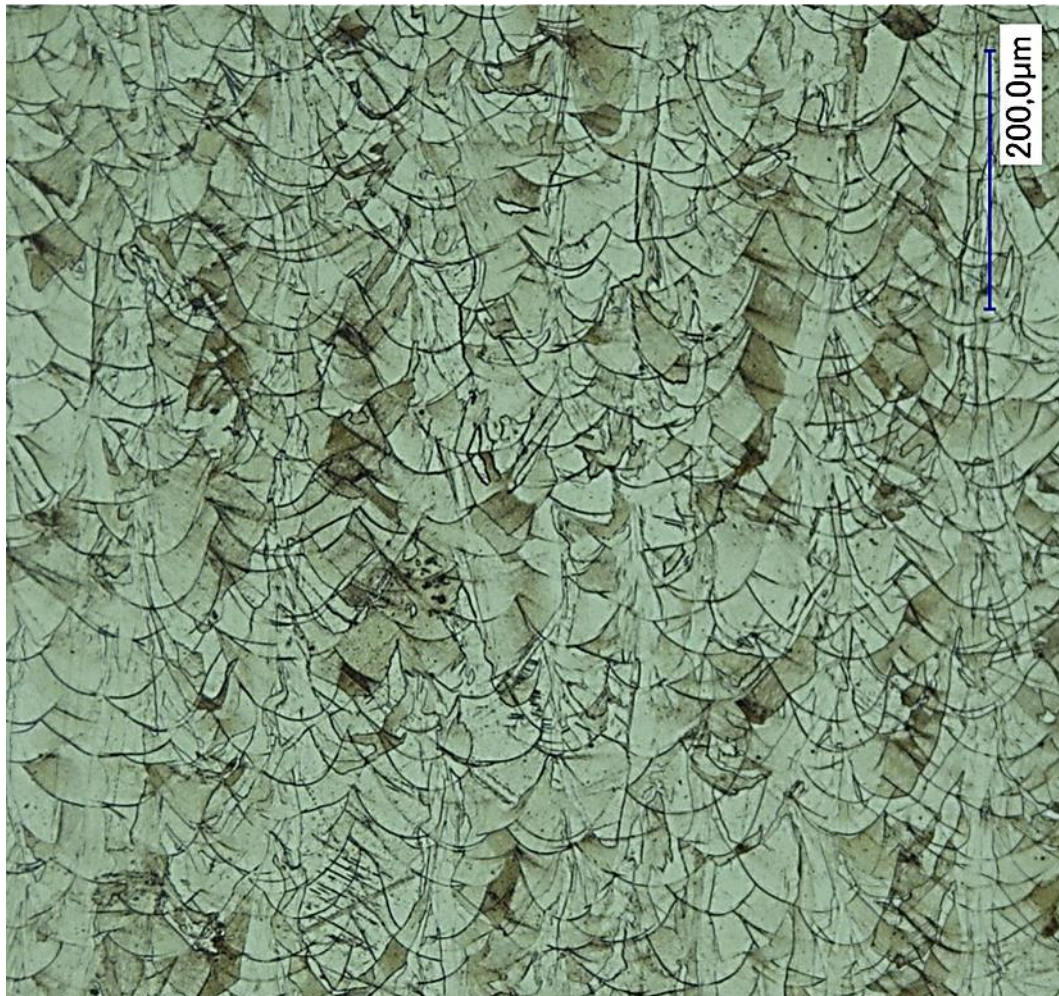
Abb. 2-19 Gefüge eines SLM gefertigten Bauteils aus 1.4404 in Aufbaurichtung
