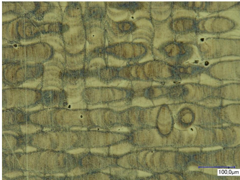
Abb. 3-25 Schmelzspuren im Querschliff. Deutlich zu erkennen ist die Fehlerhäufig im Überlappungsbereich der Schmelzspuren
