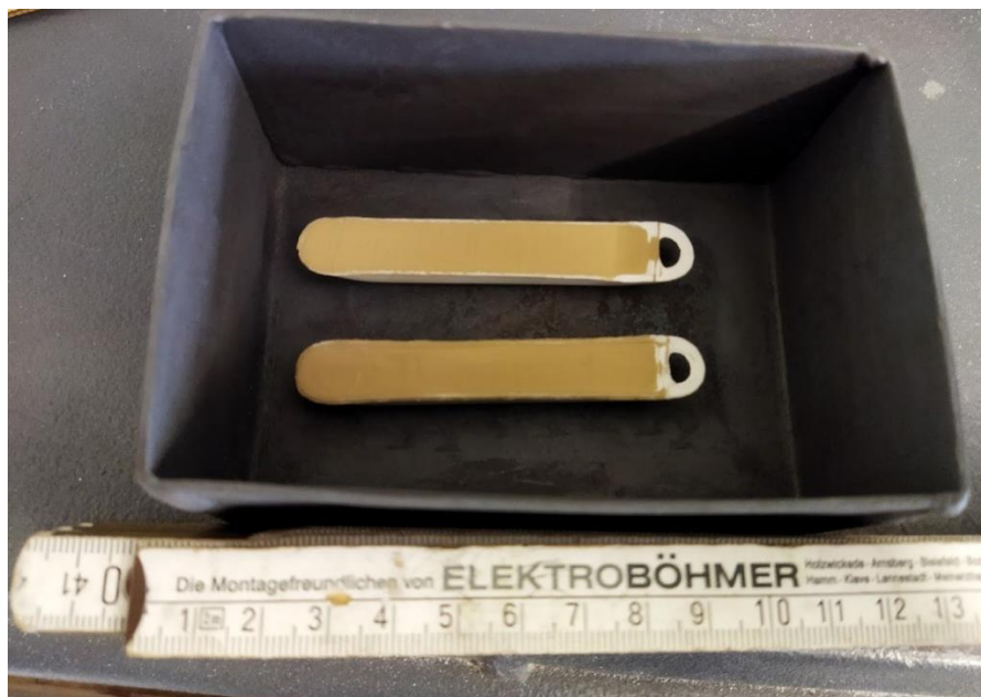
Abb. A-3 Pulverproben in Keramiktiegeln vor dem Aufschmelzen
