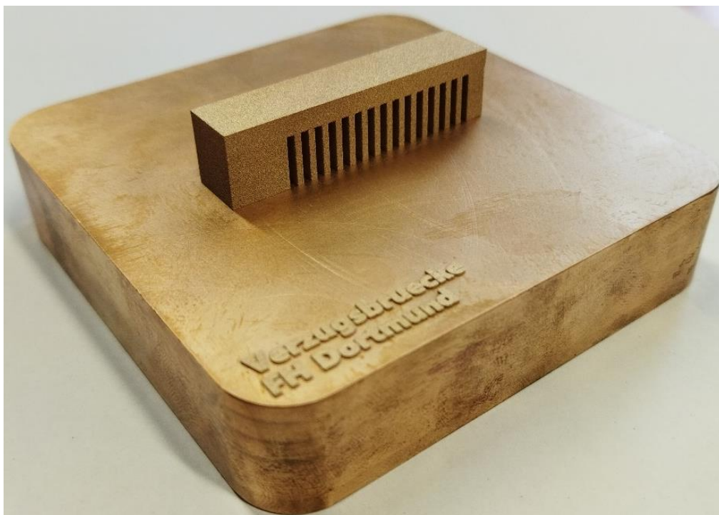
Abb. 3-57 Für die Eigenspannungsmessung gefertigte Verzugsbrücke
