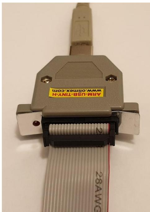
Abbildung 6: Olimex ARM-USB-TINY-H JTAG Adapter
