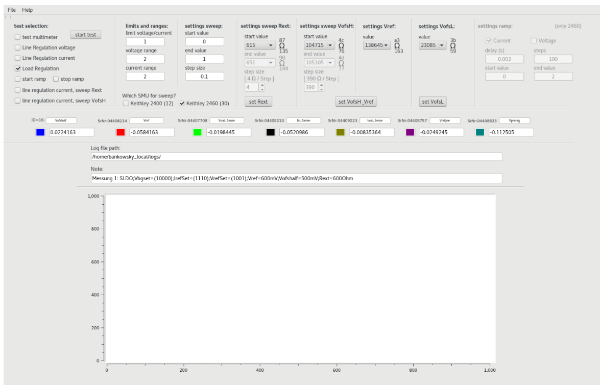
Abbildung 59: GUI der SLDO-Messsteuerungs-Software [MAC]
