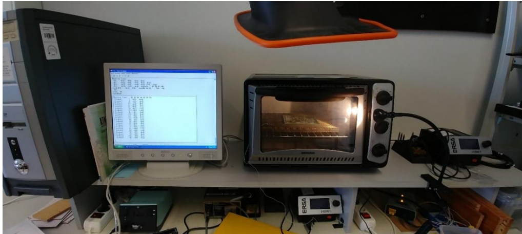
Abbildung 114: Arbeitsplatz inklusive des PCs, Klimakammer, Absaugung und Lötstation
