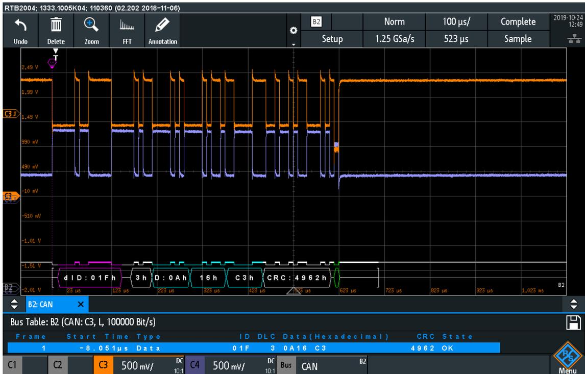
Abbildung 46: Die an den CAN\_Controller gesendete Nachricht mit den Daten 0x0A16C3.
