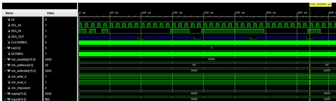
Abbildung 30: Testbench 0-370  $\mu$ s, 1. Schreibzugriff.
