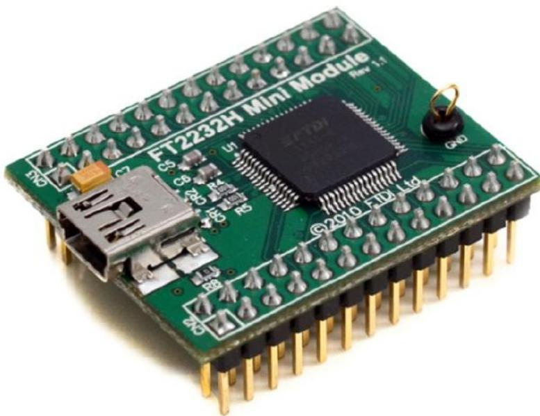
Abbildung 41: FT2232H Mini Module [11, p. 1]
