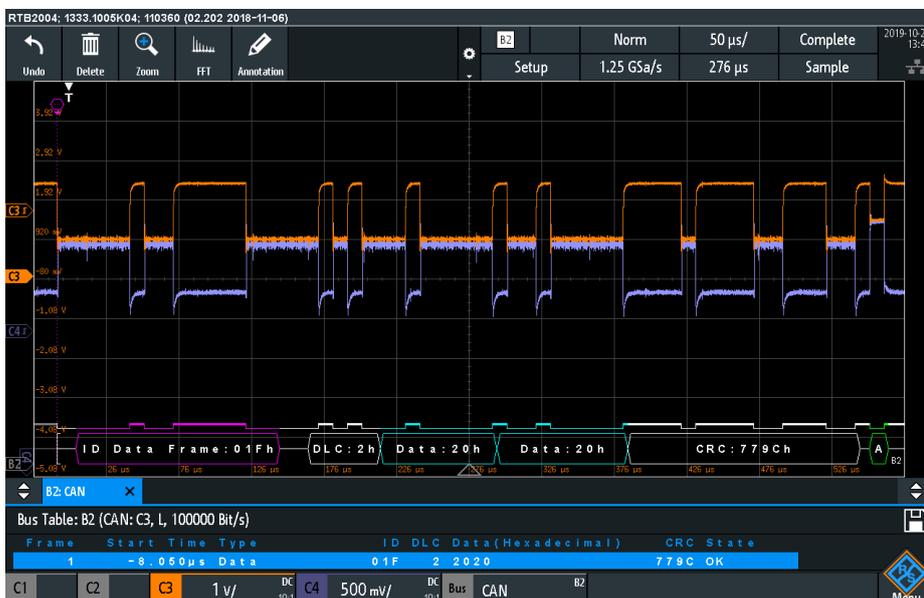
Abbildung 49: Über I2C versendete CAN-Nachricht, mit den Daten 0x2020.
