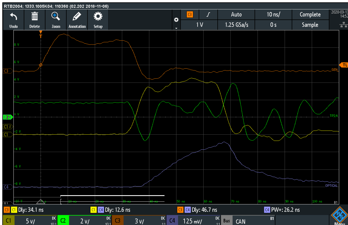
Abbildung 15: Zeitliches Verhalten der HS-Schaltung
