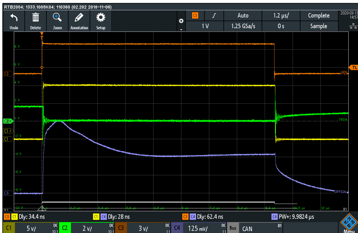
Abbildung 16: Gleichbleibende Lichtintensität bei einem 10 \mu\text{s} -Puls nach etwa 5 \mu\text{s} , LS
