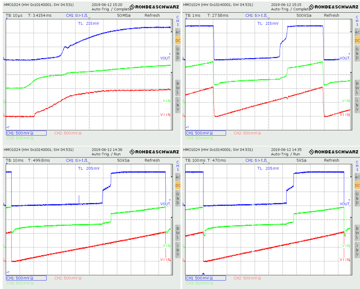
Abbildung 4.39: Einschaltverhalten von Testchip 1 im SLDO-Modus mit I_{in} = 0\text{ A} - 1\text{ A} - HPM)
