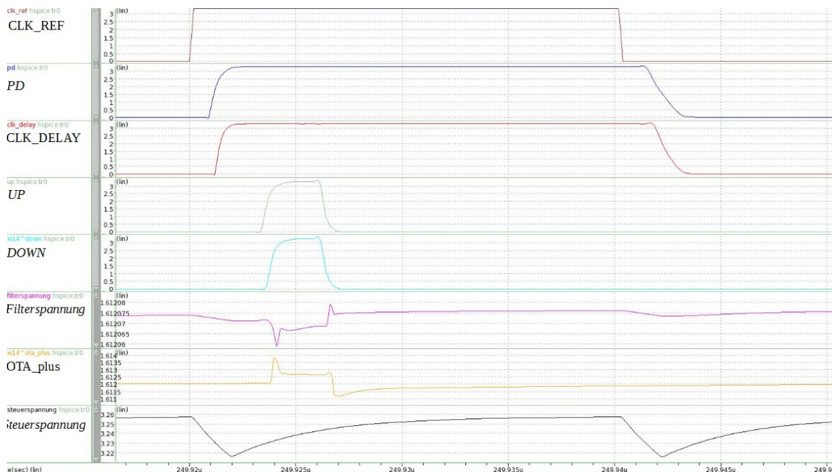
Abb. 7.5: Darstellung des Spannungsfalls auf der Steuerspannung im Schaltmoment der Delay-Line
