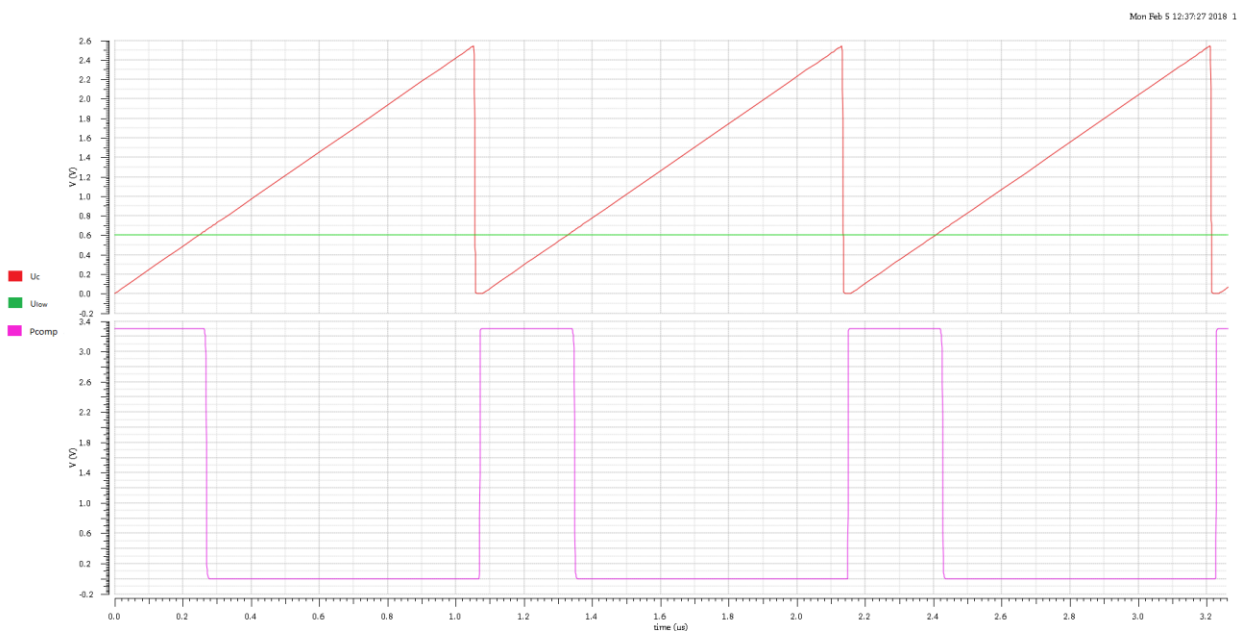
Abbildung 3.2.2: Das Verhalten des Komparators (Pcomp).
