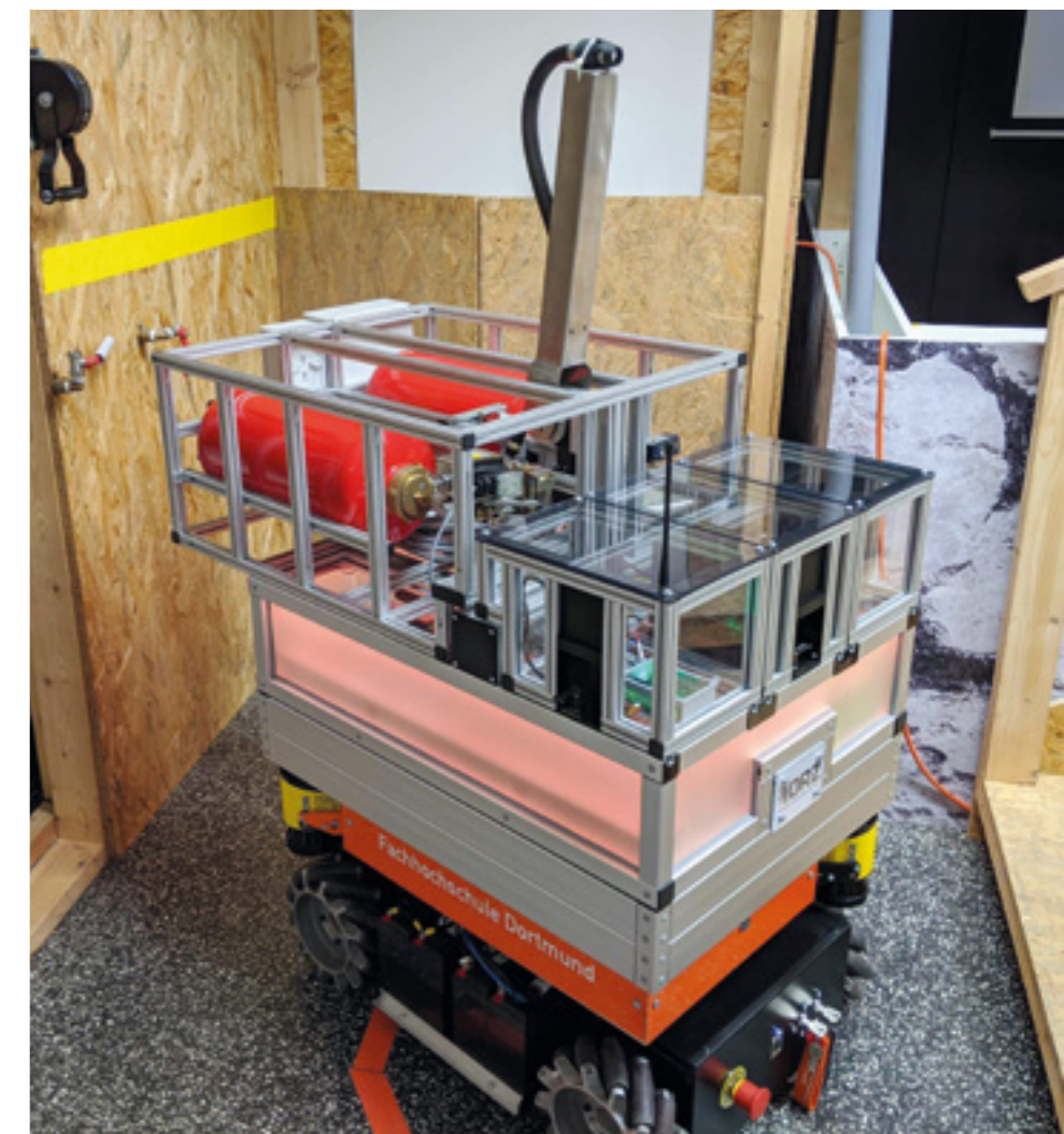
▲ Umsetzung des Modularisierungskonzeptes: Mobilitätsplattform mit Modulträger, Löschmodul und weiteren Modulen Foto: FH Dortmund
