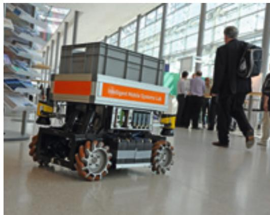
Abbildung 1: Omnidirektionaler Roboter des Intelligent Mobile Systems Lab der Fachhochschule Dortmund auf der medLogistica 2011 in Leipzig. (Foto: Leipziger Messe GmbH / Uwe Frauendorf)
