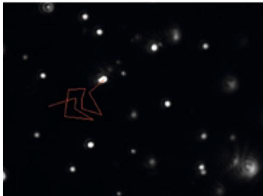
Abbildung 4: Registrierung des Beugungsmusters von Nanopartikeln in wässriger Lösung mit Hilfe von Laserstrahlen und Visualisierung mit Hilfe einer Mikroskopkamera (obere Abbildung: Messprinzip). Bestimmung der Partikelgröße durch Partikeltracking (untere Abbildung).
