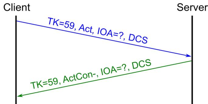
Abbildung 2.18: Negative Befehlsaktivierung: Schalthoheit Ort, EIN->EIN/AUS->AUS
