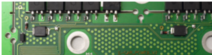
Abb. 1 Cu-Board mit Sandwichaufbau
