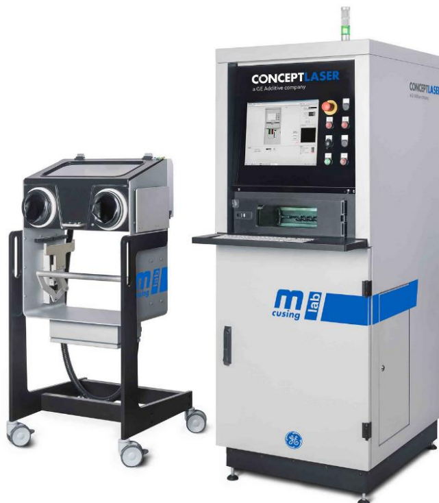
Abbildung 6-1 „Mlab cusing R“ und Handhabungsstation [29]
