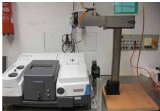
Abb. 5: FTIR-Spektrometer zur Messung des langwelligeren Spektrums
