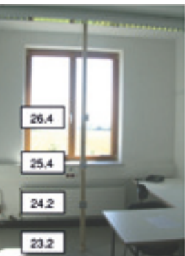
Abb. 3-22: Messraum 2.05 mit Messsäulen Standort A (links) und B (rechts) und Temperaturwerte in den unterschiedlichen Messhöhen, Ansicht von der Tür in den Raum hinein (links) Ansicht vom Fenster in den Raum hinein (rechts).
