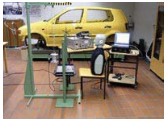
Bild 4.1: Messaufbau zur Schwingungs- und Schallemissionsanalyse einer Platte, im Hintergrund die Rohkarosserie eines VW-Polo 6N
