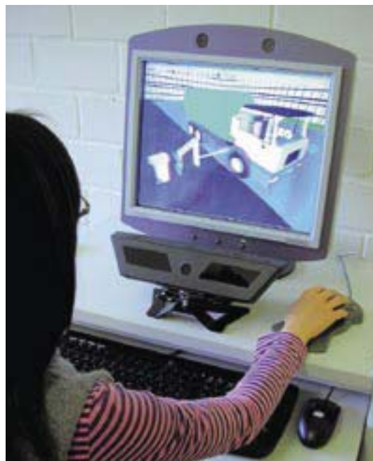
Abb. 3: Prototypische Realisierung von ErgoViz mit einem autostereoskopischen Bildschirm (SeeReal C-i) und einem Gerät zur Blickbewegungserfassung (Tobii x50).
