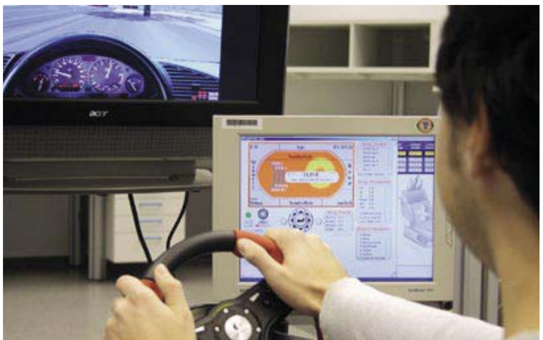
Abb. 6: Fahr- und Bediensimulation in der Multimodalen Sitzkiste
