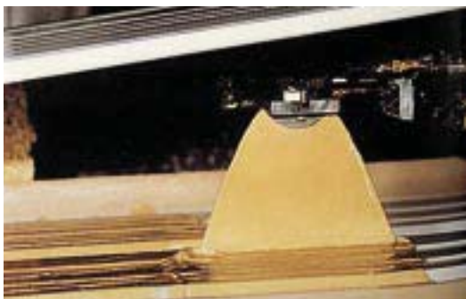
Abb. 2.6: Einbringen des flüssigen PU-Kunststoffes in die untere Blechlage. Darüber wird das obere Blech geführt
