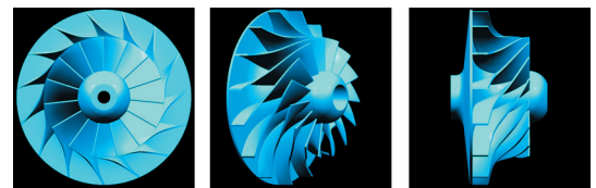
Abbildung 2.1: Dreidimensionale Ansichten des Basislaufblattes
