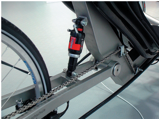
Bild 5: Hinterradschwinge aus Edelstahl: a) Konstruktion, b) FEM-Analyse, c) Fertigung
