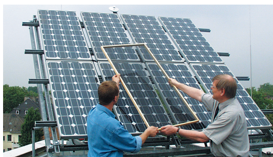
Abb. 1: R_s -Messung im Freien: Verringerung der Bestrahlungsstärke mit Fliegengitter.
