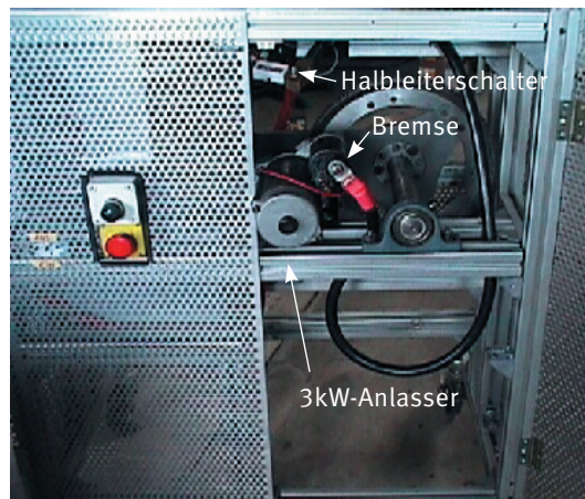
Abb. 1: Foto des Anlasserprüfstands
