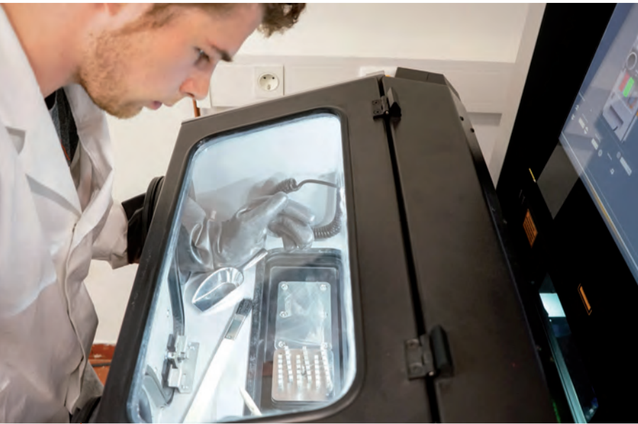
Selektives Laserschmelzen: Bachelorstudent Robert Kremer gräbt das gedruckte Bauteil aus. Foto: Axel Kopp
