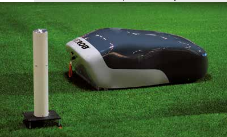
Orientierung über Funk: Flexibel aufgestellte Sender ermöglichen dem Roboter, seine Position sehr genau zu bestimmen.
