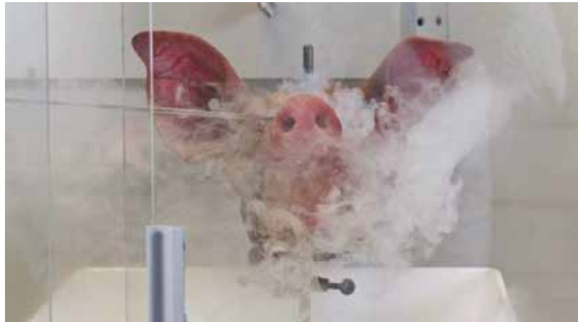
Die Uni München hat in einem Versuch für die Zeitschrift Auto Bild mit einem Schweinekopf die gefährliche Wirkung von Fluorwasserstoffgas auf Hautgewebe untersucht. Ergebnis: Schon eine handtellergroße Benetzung der Haut kann tödlich enden.
