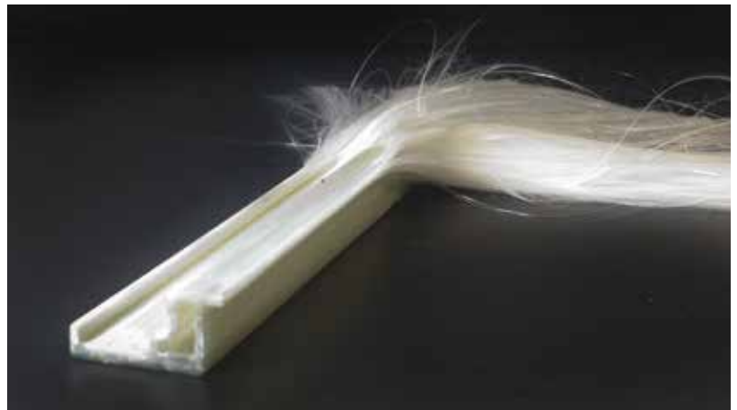
Der Rahmen des UL-Fensters besteht aus glasfaserverstärktem Kunststoff.
