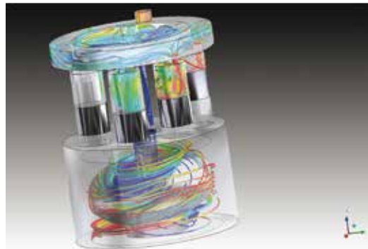
Abbildung 3: Verlauf der Stromlinien einer dreidimensionalen CFD-Analyse in einem Axialkompressor moderner Klimaanlage.
