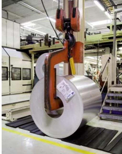
Anlieferung des Rohmaterials (Aluminium oder Stahl) in Form von Coils
