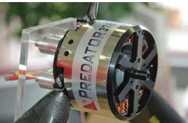
Der „Predator“ wird als Nabenmotor am E-Cart eingesetzt.
