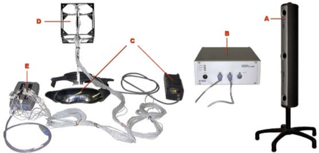
Die Ausrüstung für Versuche zum Projekt „MocapScope“ im VR-Labor des IfaDo. Der Motion Tracker ist ein mit sensiblen Kameras ausgestatteter Balken aus Metall zur optischen Bewegungserfassung.
