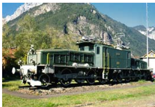
Die Lokomotive Ce 6/8 II („Krokodil“) der Schweizerischen Bundesbahnen (SBB) wurde bereits im Jahre 1919 in Dienst gestellt. Sie ist auch mit einer Rekuperations-Bremse ausgerüstet.
