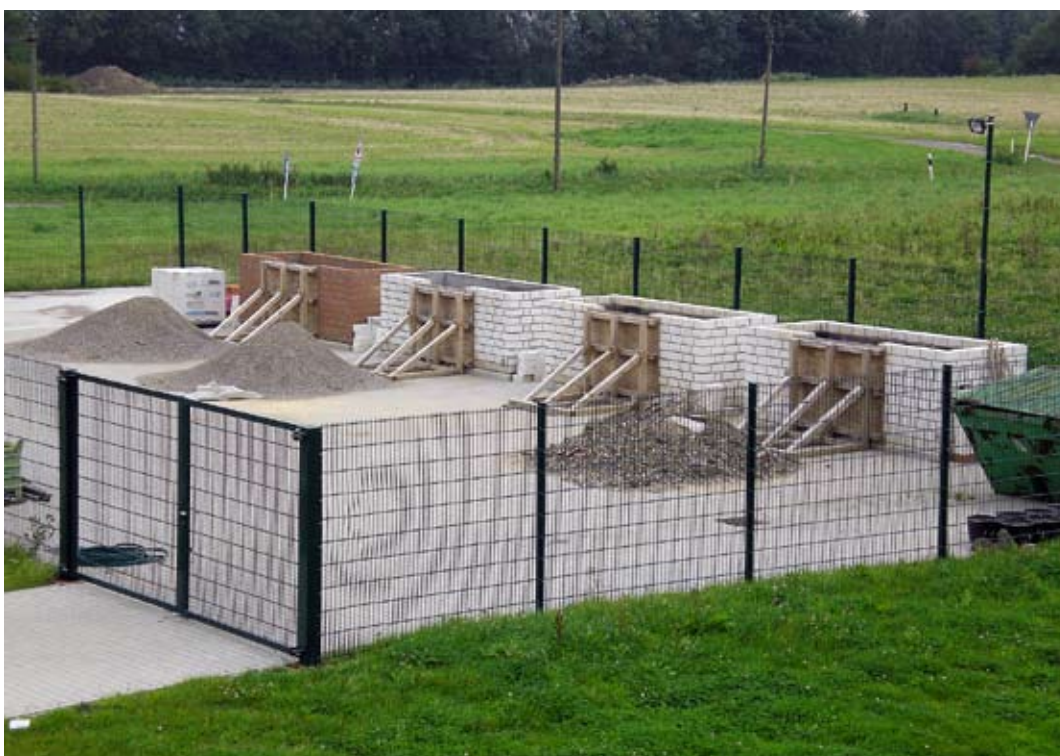
Bild 3: Prüfstände für Vergelungsversuche auf dem Freigelände
