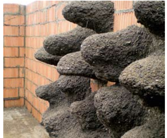
Bild 6: Mangelhafter Vergelungserfolg durch zu hohem Injektionsdruck
