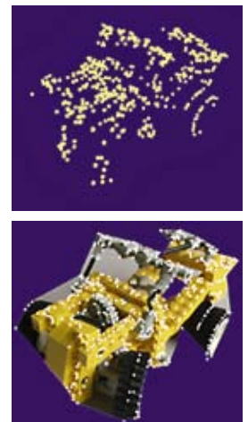
Aus korrespondierenden Punkten generiert das System eine Punktwolke und verkleidet dieses „Gerüst“ mit der entsprechenden Oberfläche.
