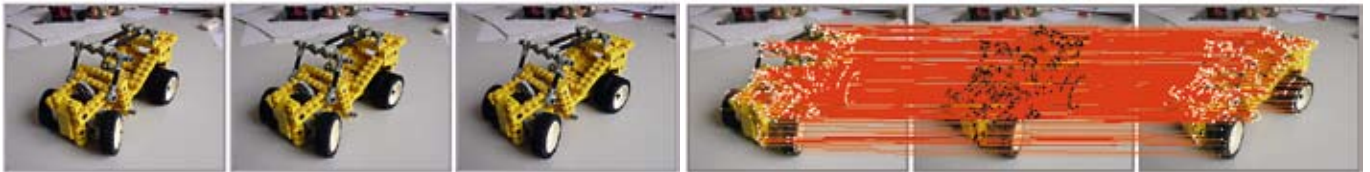
Das von Professor Peters entwickelte System zur Freihanderfassung sucht auf drei Fotos eines Gegenstands nach markanten Punkten. Insbesondere solche Punkte, die auf Ecken und Kanten liegen, werden auf allen drei Bildern erfasst, und zueinander ins Verhältnis gesetzt.
